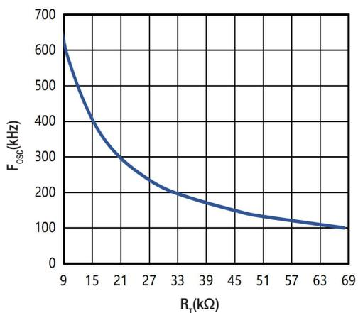
Fig. 11. F<sub>OSC</sub> vs R<sub>T</sub>
